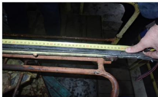
Foto nr.13 - Lungimea saniei portperii pantografului EP2
