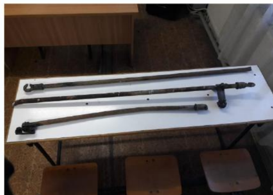
Foto nr.15 – Fixtoare (avariate) de susținere și asigurare a geometriei firului liniei de contact
