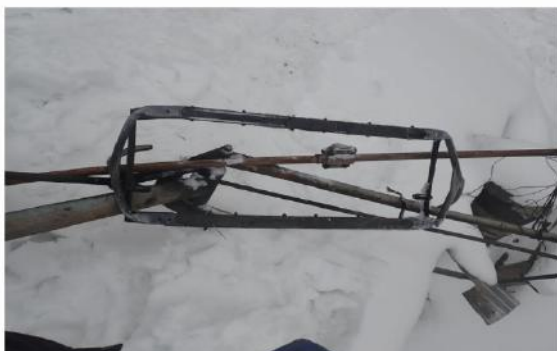
Foto nr.10 - Pantograful tip EP3 avariata al locomotivei EA305
