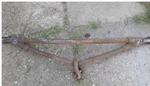
Fotografia nr.14. Axa triunghiulară osia 7-8 deformată
