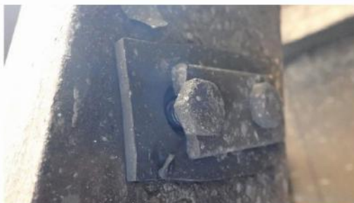
Fotografia nr.11. Etrier siguranță rupt roata nr. 5
