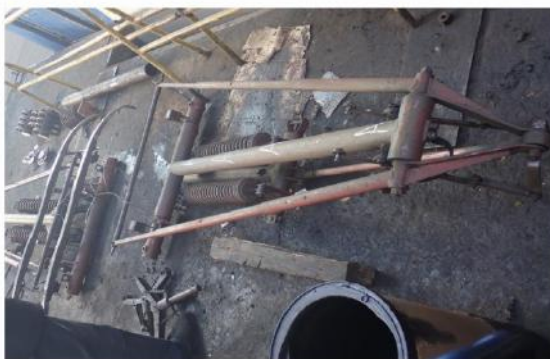
Foto nr.8 - Cadre pantografe „A” și „B” ale locomotivei EC126 fără deformări, loviri sau urme de flămăre
