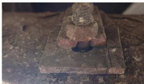
Fotografia nr.9 Sistem prindere etrier siguranță roata nr.8
