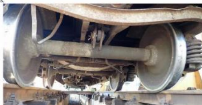
Fotografia nr.13.Etrier siguranță lipsa, roata nr. 8,
