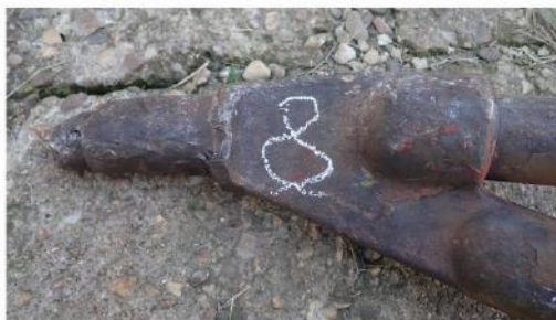
Fotografia nr.15. Conexiunea A1, axă triunghiulară –port sabot
